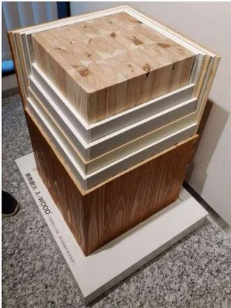
熊谷組の木質耐火部材「断熱耐火 λ-WOOD (ラムダウッド)」の断面。中央が「荷重支持部 (集成材)」、中間が「燃え止まり層 (炭化材)」、外側が「化粧材 (表面仕上げ材)」 (写真: 熊谷組)
