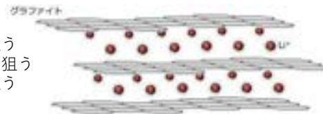
リチウムイオンが挿入されたグラファイトの模式図
